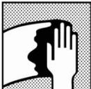
Entfernen Sie vor dem Auftragen des Decklackes jegliche Oberflächenverunreinigung unter Verwendung entsprechender Oberflächenreiniger.
