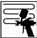
Eine Schicht komplett über die geschliffene Fläche auftragen. Anschließend eine zweite Schicht innerhalb der vorangegangenen Schicht auftragen.
