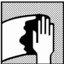
Vor dem Schleifen Oberfläche mit Lesonal Reinigern/Entfettern gründlich reinigen.
