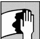
Nach Beendigung des Schleifvorgangs, Oberfläche noch einmal gründlich mit Lesonal Reinigern/Entfettern reinigen.
